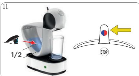
11 Compruebe visualmente cuando el depósito de agua esté medio lleno. Empuje la palanca de selección a la posición "PARADA".
