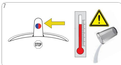
Después de aprox. 30 segundos, mueva la palanca de selección a la posición «PARADA». Retire y vacíe el depósito. **¡Advertencia: agua caliente! ¡Proceda con cuidado!**
