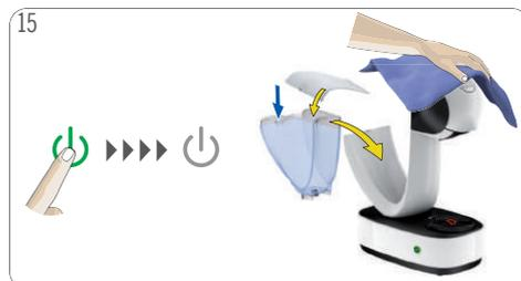
15 Apague la máquina. Llene el depósito con agua potable fresca. Insértelo de nuevo en la máquina. Limpie la máquina con un paño húmedo y suave. Séquela después con un paño seco y suave.
