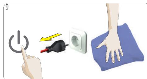
Apague la máquina. Desenchufe el enchufe de alimentación. Limpie la máquina con un paño húmedo y suave. Séquela después con un paño seco y suave.
