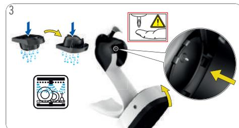
Limpie con líquido detergente y agua potable fresca ambos lados del soporte de la cápsula. Como alternativa puede lavarse en el lavavajillas. Séquelo a continuación. Limpie el cabezal de la máquina alrededor del inyector con un trapo húmedo suave y limpio.
