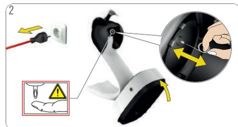
2 Desenchufe el enchufe de alimentación. Incline la máquina para acceder mejor al inyector. ¡No toque nunca el inyector con los dedos! Limpie el inyector con la aguja de limpieza. Siga las instrucciones de 8. «Descalcificar al menos cada 3 ó 4 meses» en la página 14.
