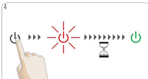
Encienda la máquina. El botón de encendido comienza a parpadear en rojo mientras la máquina se calienta durante aproximadamente 40 segundos. A continuación, el botón de encendido se ilumina permanentemente en verde. La máquina está lista para utilizarse.
