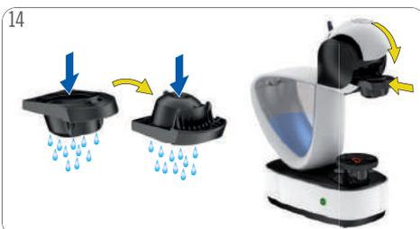
14 Enjuague el soporte de la cápsula con agua potable fresca por ambos lados. Seque el soporte de la cápsula. Insértelo de nuevo en la máquina. Disfrute de su bebida.
