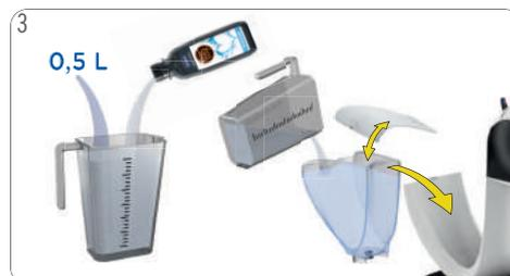
3 Mezcle 0,5 litros de agua potable fresca con descalcificador en un recipiente de medición. Vierta la solución de descalcificación en el depósito de agua e inserte el depósito de agua en la máquina.
