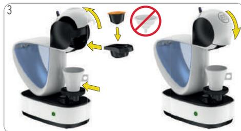
Coloque una taza del tamaño correcto sobre la bandeja recoge gotas. Vea 3. «EJEMPLOS DE BEBIDAS» o el paquete. Abra la manija de bloqueo. Retire el soporte de la cápsula. Asegúrese de que la herramienta de enjuague no esté dentro. Inserte la cápsula en el soporte de la cápsula. Insértelo de nuevo en la máquina. Cierre la manija de bloqueo.
