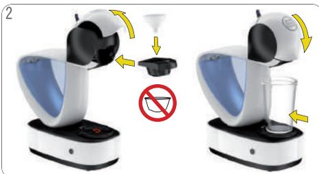
Abra la manija de bloqueo. Asegúrese de que la herramienta de enjuague esté en el soporte de la cápsula y que el soporte de la cápsula esté en la máquina. Cierre la manija de bloqueo. Coloque un depósito grande vacío debajo de la salida de café.
