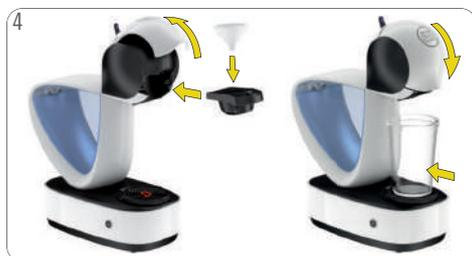
Abra la manija de bloqueo. Ponga la herramienta de enjuague dentro del soporte de la cápsula. Inserte el soporte de la cápsula en la máquina. Cierre la manija de bloqueo. Coloque un depósito grande vacío debajo de la salida de café.
