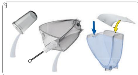
9 Vacíe y limpie el depósito. Enjuague y limpie el depósito de agua. Use un cepillo limpio seguro para alimentos y detergente líquido según sea necesario. A continuación, rellene el depósito de agua con agua potable fresca e insértelo en la máquina.
