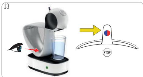
13 Compruebe visualmente cuando el depósito de agua esté vacío. Empuje la palanca de selección a la posición "PARADA".
