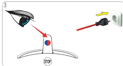
Asegúrese de que la palanca de selección esté en la posición "PARADA". Asegúrese de usar la tensión eléctrica correcta tal como figura en 2. «DESCRIPCIÓN GENERAL DE LA MÁQUINA» en la página 5. Conecte el enchufe de alimentación a la toma de corriente.
