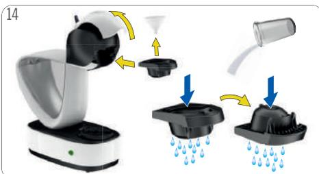
14 Abra la manija de bloqueo. Retire el soporte de la cápsula. Retire la herramienta de enjuague. Enjuague el soporte de la cápsula con agua potable fresca por ambos lados. Vuelva a insertar el soporte de la cápsula.
