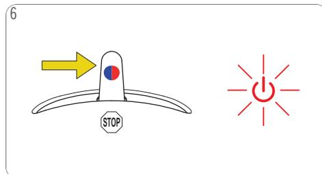
Después de aproximadamente 60 segundos, mueva la palanca de selección a la posición "PARADA". La máquina detiene el enjuague. El botón de encendido parpadea en rojo durante aproximadamente 5 segundos.
