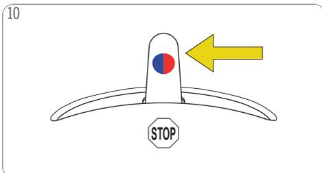
10 Manténgase al lado de la máquina a lo largo de la preparación. Después de alcanzar el nivel deseado, mueva la palanca de selección a la posición "PARADA". La máquina detiene la preparación.
