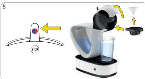
Después de aproximadamente 60 segundos, mueva la palanca de selección a la posición "PARADA". Abra la manija de bloqueo. Retire el soporte de la cápsula. Retire la herramienta de enjuague. Vuelva a insertar el soporte de la cápsula.
