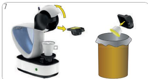
Abra la manija de bloqueo. Retire el soporte de la cápsula. Retire la cápsula usada. Tire la cápsula usada en el contenedor de residuos.
