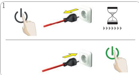
1 Apague la máquina. Desenchufe el enchufe de alimentación y espere 20 minutos. Retire el soporte de la cápsula y deseche la cápsula. Transcurrido este tiempo, enchufe el cable de alimentación en la toma de corriente y encienda la máquina.
