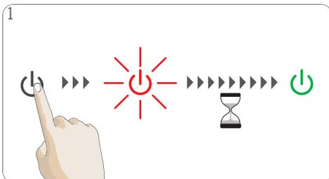
Compruebe si el depósito de agua contiene suficiente agua potable fresca. Encienda la máquina. El botón de encendido comienza a parpadear en rojo mientras la máquina se calienta durante aproximadamente 40 segundos. A continuación, el botón de encendido se ilumina permanentemente en verde. La máquina está lista para utilizarse.
