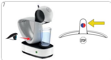
7 Compruebe visualmente cuando el depósito de agua esté vacío. Empuje la palanca de selección a la posición "PARADA".
